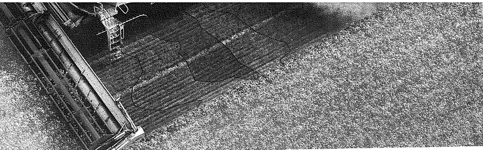
Der Mähdrescher misst kontinuierlich die Ernteleistung – die daraus errechnete virtuelle Karte zeigt, wo Dünger gefehlt hat
